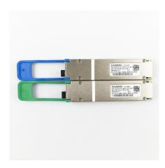
Приемопередатчик Huawei BiDi, QSFP28, 1295 нм ТХ, 1309 нм RX, 50G, 1,5 дБм, 8 дБм, -13,5 дБм, LC, SMF, 40 км 02312EVX
