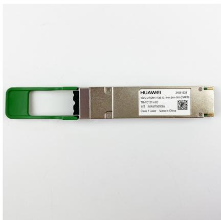
Высокоскоростной приемопередатчик Huawei, QSFP28, 1310 нм, 100G, -6,5 дБм, 2,5 дБм, -10 дБм, LC, SMF, 2 км, CWDM4
