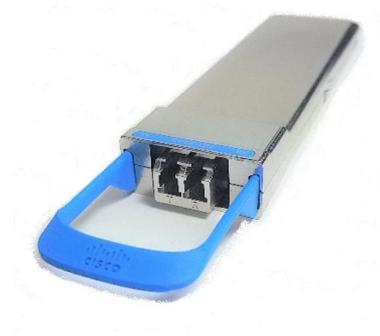
Модуль Cisco CPAK-100GE-LR4 100GBASE-LR4 CPAK для SMF (заканчивается разъемами LC)
