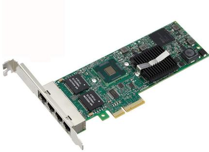
Четырехпортовый серверный адаптер Intel Gigabit ET2, 82576, Gigabit Ethernet, четырехпортовый, медный разъем RJ45
