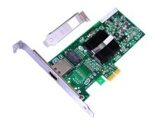
Серверный адаптер Intel PRO/1000 PT, 1 разъем RJ45, 10/100/1000, PCIe, 82572Gl
