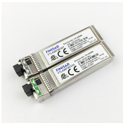
II-VI Приемопередатчик Finisar 10 Гбит/с TX-1271nm RX-1331nm SMF 10 км BIDI SFP+
