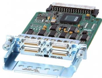
Cisco HWIC-4A/S 4-портовый асинхронный/синхронный последовательный HWIC
