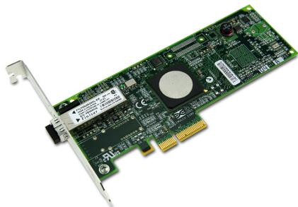
Emulex LPe1150 4Gb PCIe 2.0 Однопортовый адаптер хост-шины Fibre Channel
