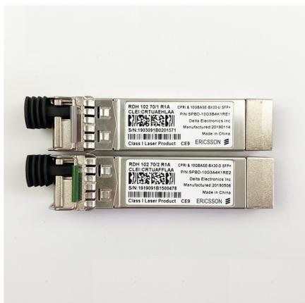
Модуль приемопередатчика Ericsson RDH10270/2 CPRI и 10GBASE-BX20-D SFP+ BIDI SPBD-10G3A4K1RE2
