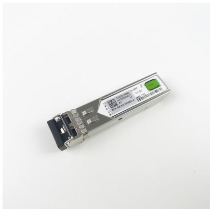
Модуль приемопередатчика H3C 1000BASE-SX SFP 850nm 550m DOM LC MMF
