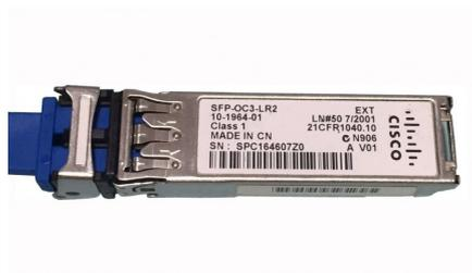
Cisco SFP-OC3-LR2 SFP OC-3/STM-1 Большой радиус действия (80 км)
